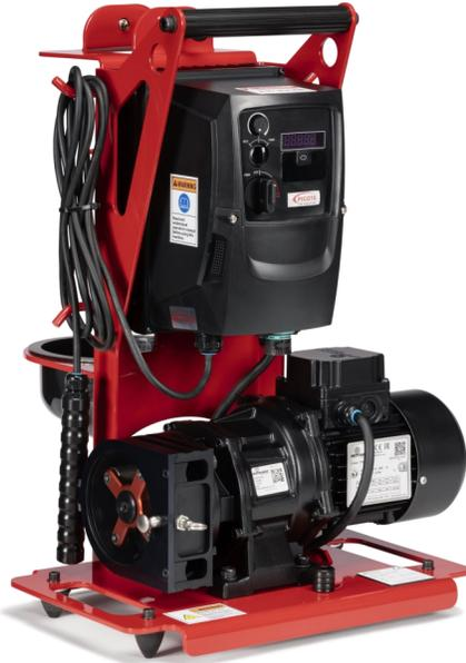
Das Picote Brush Coating™-System ist eine einfache, schnelle und praktische Beschichtungslösung für die Sanierung von Abflüssen, Abwasserkanälen, Wasserrohren, elektrischen Leitungen, Heizungs- und Klimakanälen und mehr.
