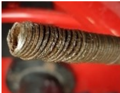
Beschädigte Welle – muss gekürzt werden
