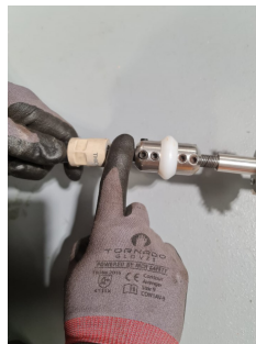
Korrektur Abstand zwischen Endkappe und Smart Cutter™ Hub
