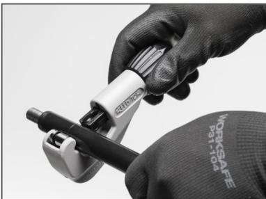
Überprüfen Sie die Wellenummantelung vor jedem Gebrauch. Der einfachste und sicherste Weg, die Ummantelung auf die richtige Länge zu kürzen, ist die Verwendung eines Wellenschneiders. Die Welle sollte nie mehr als die notwendige Länge ohne Ummantelung aufweisen.
