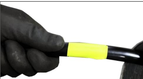
Wenn Sie keine Opferwelle verwenden, bringen Sie eine optische Markierung (Klebeband) an der Ummantelung der flexiblen Welle an. Platzieren Sie sie etwa 500mm vor dem Ende der Welle. Die Markierung zeigt die Position des Werkzeugs an und hilft, mögliche Verletzungen durch rotierende Teile zu vermeiden, indem Sie gewarnt werden, wenn das Werkzeug aus dem Rohr kommt.
