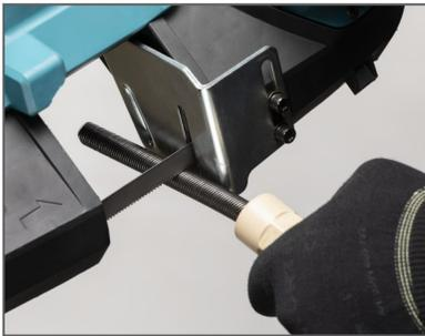
Überprüfen Sie die flexible Welle vor jedem Gebrauch. Lassen Sie die Maschine kurz im Uhrzeigersinn laufen, damit die Welle in ihre Ruheposition zurückkehrt. Bei möglichen Schwachstellen oder Beschädigung der Welle, kürzen Sie die Welle um die beschädigte Länge mit einer Bandsäge. Bei den meisten Werkzeugen sollte die Welle ~40 mm über das Gehäuse hinausragen. Hubs und Original Ketten ohne Opferwelle erfordern eine weiter herausragende Welle.
