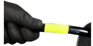
Die Markierung zeigt die Position des Werkzeugs an und hilft, mögliche Verletzungen durch rotierende Teile zu verhindern, indem sie Sie warnt, wenn das Werkzeug kurz davor steht, aus dem Rohr zu treten.
